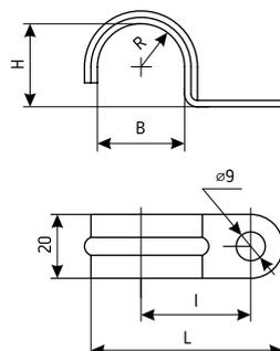
Изготавливаются из стали с гальваническим покрытием.
